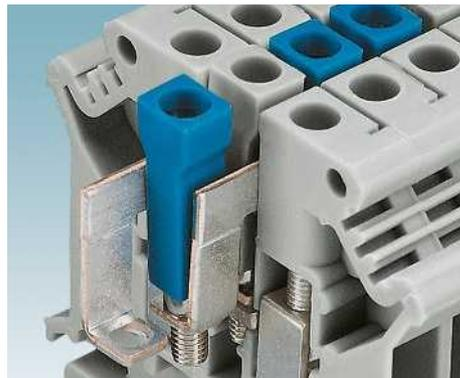
L-образная перемычка LB ... позволяет проводить через канал шунтирования две различные цепи питания, используя до 100 клемм. Изолированные цветные контактные винты используются для обозначения цепей.
