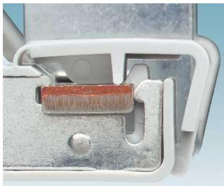
Нейтральная магистральная шина 3 x 10 мм также быстро вводится в контактную зону. Благодаря этому производится автоматическое соединение магистральной шины с потенциалом земли.
