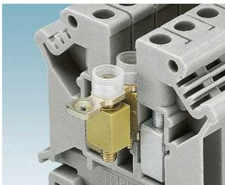
Коммутационные перемычки с изоляцией ISSBI ... в сочетании с изолирующей перемычкой IS ... позволяют создавать коммутируемые поперечные соединения. При этом винт выполняет функцию токопроводящего коммутационного элемента.
