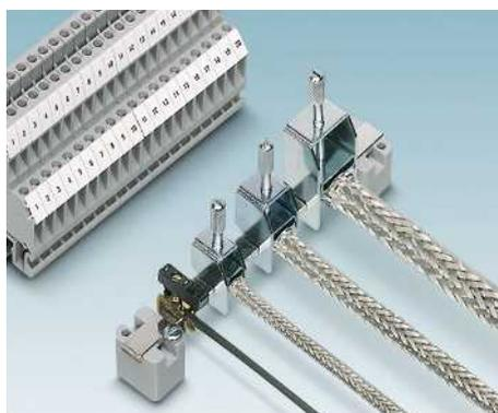
В качестве альтернативного варианта экранирующая оплетка может быть подключена к потенциалу корпуса устройства с изоляцией относительно защитного заземления. При этом соответствующее соединение с нейтральной магистральной шиной обеспечивается отводящей клеммой.
