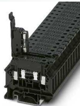
4 (6) мм<sup>2</sup>, 6,3 А, рычажная клемма с держателем предохранителя, для стеклянных предохранителей 5 x 20 мм
