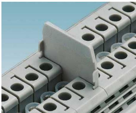
Разделительный диск TS ... предназначен для электрического и оптического разделения соседних перемычек. Для поддержания полного номинального напряжения клемм с обеих сторон перемычки должен быть предусмотрен разделительный диск.
